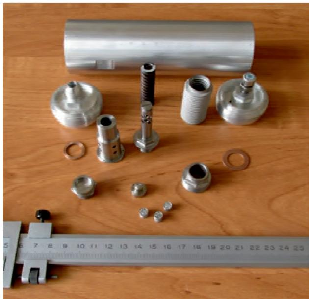
**Рис. 4. Акустический демпфер в разборе**
